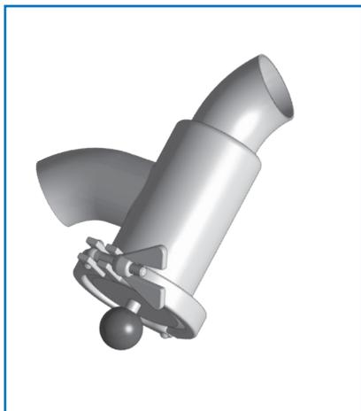
Les factres en Y AWH protègent le produit et les pièces de l'installation, les pompes, échangeurs thermiques, etc., des dysfonctionnements dus à des corps étrangers. L'exécution correspond à celle d'une forme à siège oblique (factre en Y). Le sens d'écoulement va de l'intérieur vers l'extérieur. La position de montage doit être telle que l'insert du factre se retire vers le bas. Le contour du factre favorable à l'écoulement permet des processus plus sûrs de manière simple et peu coûteuse.
